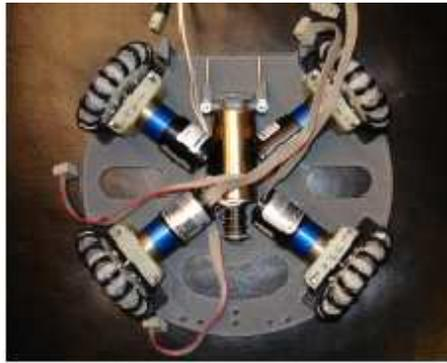
Figura 4.16 Alineación de los motores respecto al sistema de referencia.
