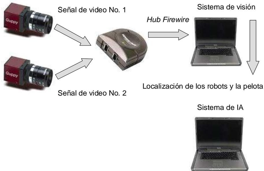
**Figura 5.4.** Entradas y salidas del sistema de visión hacia el sistema de IA.
