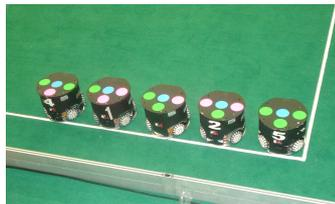
**Figura 1.3.** Codificación de parches del equipo de robots SSL.
